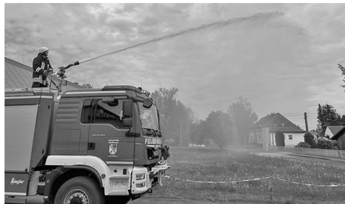
Vorführung des Dachmonitors des Tanklöschfahrzeugs (kurz TLF), stationiert bei der Ortsfeuerwehr Deschka
